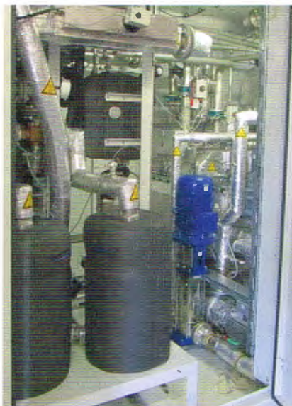
Die Lösemittelaufbereitung mit kontinuierlichem Austrag des ausdestillierten Öl-Zinkstearat-Lösemittelgemischs sorgt für eine lange Standzeit des Reinigungsmediums und einen geringen Stabilisatorverbrauch
