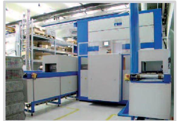
单腔设备，带自动上下料装置
