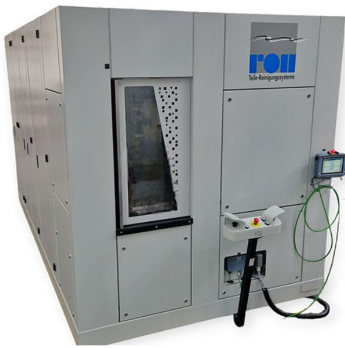
Effiziente Lösung für das Entgraten und Reinigen in einem Arbeitsschritt: FlexJet HD von Karl Roll (Bild: Roll)
